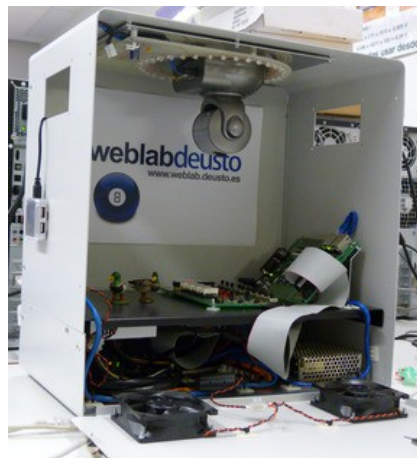
Figura 1. Weblab-box desarrollada en la UD para una sencilla implementación de laboratorios remotos
